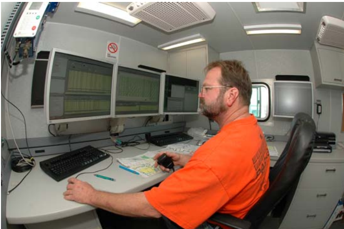
Típica configuración central de electrónicas en el camión de grabación.
