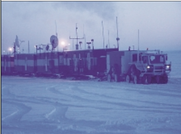
Рис. 5. Один X-Vib тянет за собой пять трейлеров с поевым лагерем
