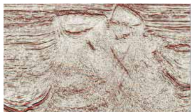
Алгоритм PreSDM по Кирхгофу, разработанный GXT, позволяет отображать сложные геологические структуры с сохранением их амплитуды. С помощью функции искривления лучей можно получать изображения очень крутых наклонов, опрокинутых границ соли и разломов
