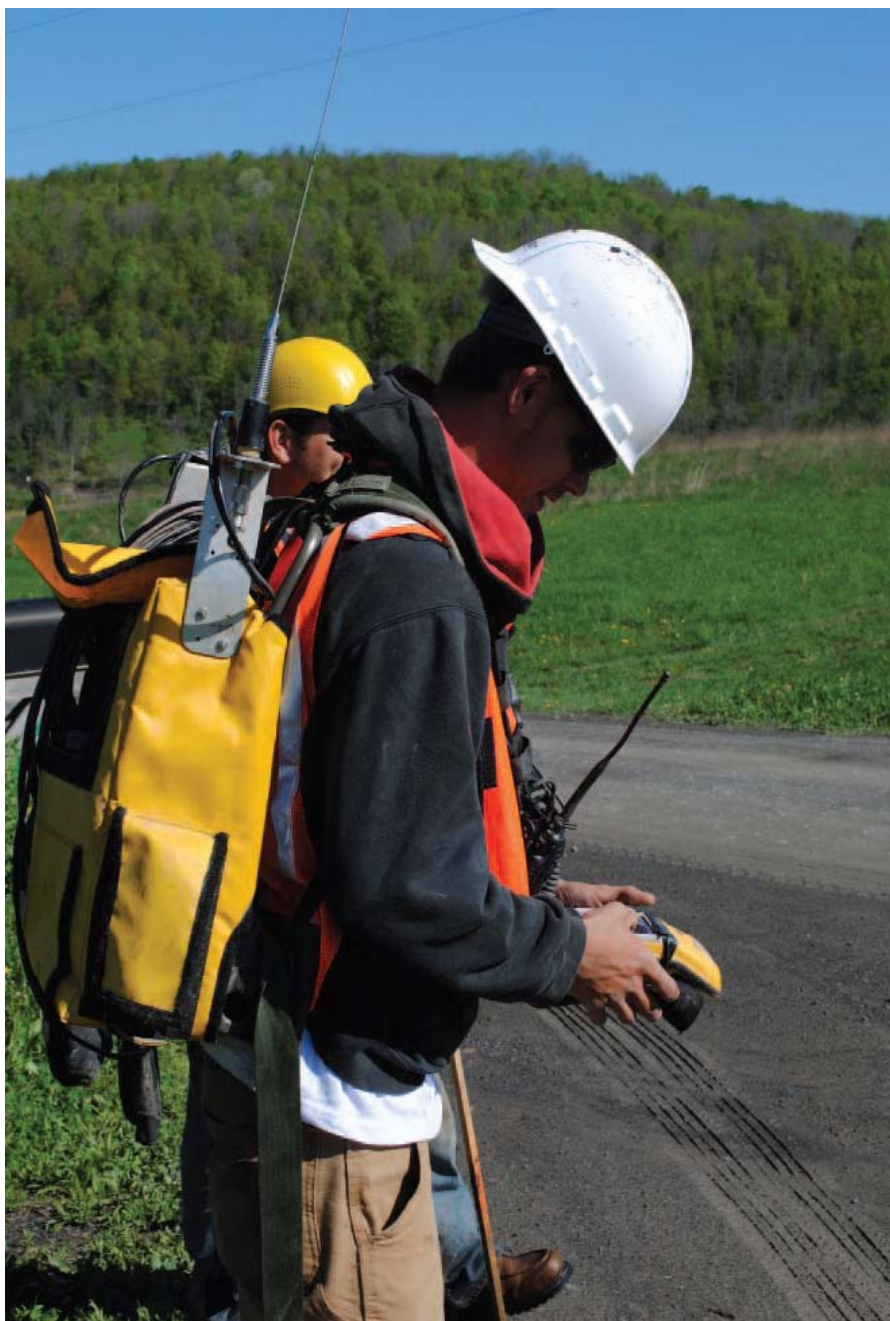
这个勘探队员通过使用FireFly的导航仪器, 可以安全并且迅速的从一个炮点移到另一个炮点, 这个导航仪器是Connex的一个部件, 可以容易的辨认与测量有关的危险和以外的区域。
